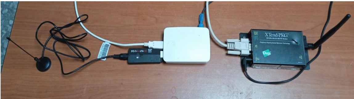
Figura 5: Montaje del sistema transpondedor para las pruebas de validación.
