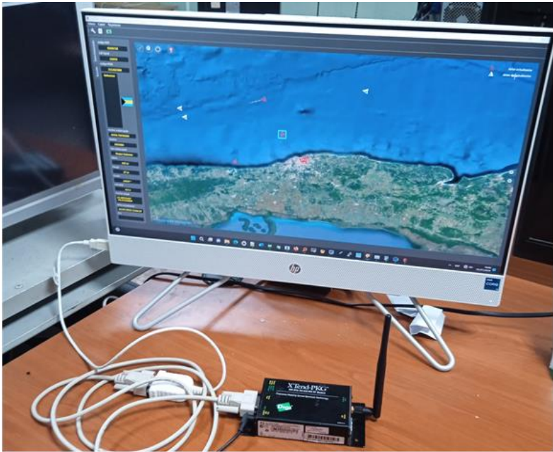
Figura 4: Montaje del centro de control para las pruebas de validación.
