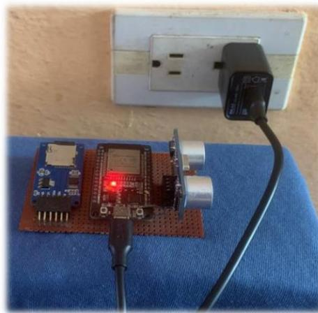
Figura 4. Módulo de adquisición de datos construido.
