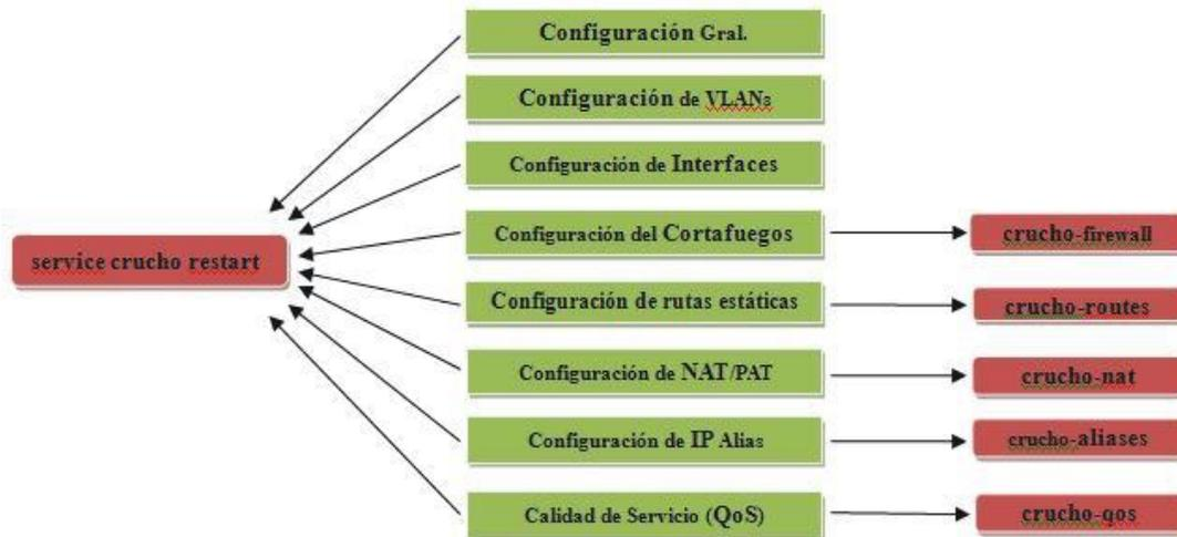
Fig 2. Proceso de activación de configuraciones de cRucho
