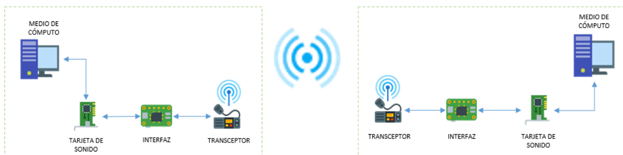
Figura 1: Diagrama de bloques del sistema APRS propuesto.
