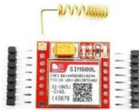
Figura 5: Imagen del módulo SIM800L.
