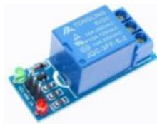
Figura 13: Relé tipo JQC- FF-S-Z.
