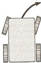
Figura 6.1: Giro en configuración Ackerman.
