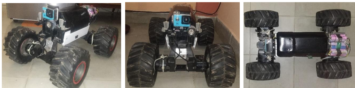
Figura 14: Vistas isométrica, frontal y superior del vehículo tele operado (de izquierda a derecha).
