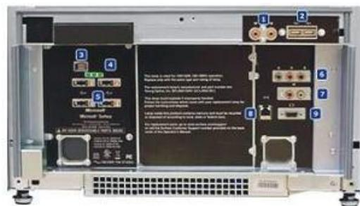
**Figura 3: Conexiones**
