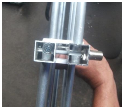
Figura 11: Colocación del conector F Hembra en la antena ADM 010.
