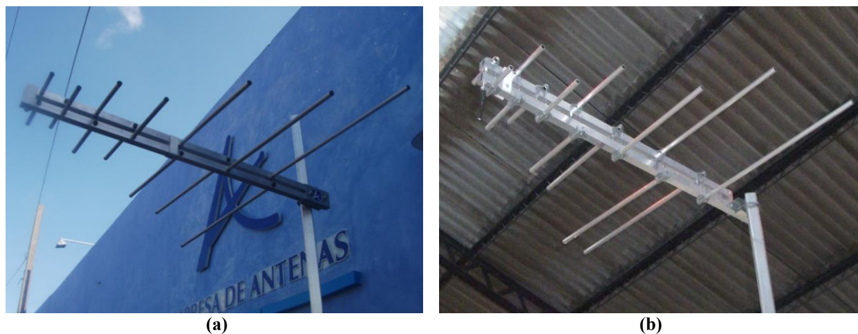
Figura 12: Últimas antenas ADM 010 propuestas bajo pruebas. (a) Antena con elementos insertados al boom y (b) antena con elementos fijados con porta elementos metálicos fijados al boom.
