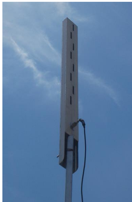
Figura 10: Modelo prototipo de la antena SWA con sonda coaxial.
