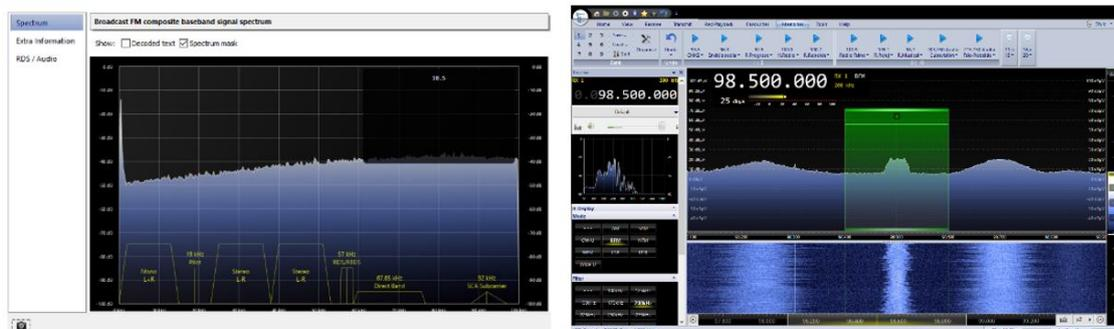
Figura 10: Situación espectral emisora Radio Musical, en la frecuencia 98,5 MHz.
