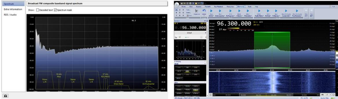
Figura 8: Situación espectral emisora Radio Enciclopedia, en la frecuencia 96,3 MHz.
