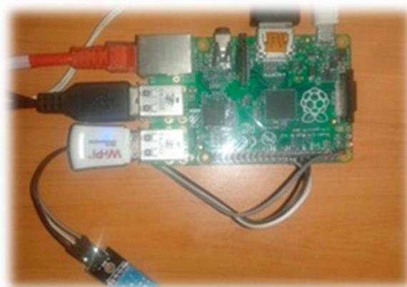
Figura 2: Conexión del sensor DHT11 con la Raspberry Pi.
