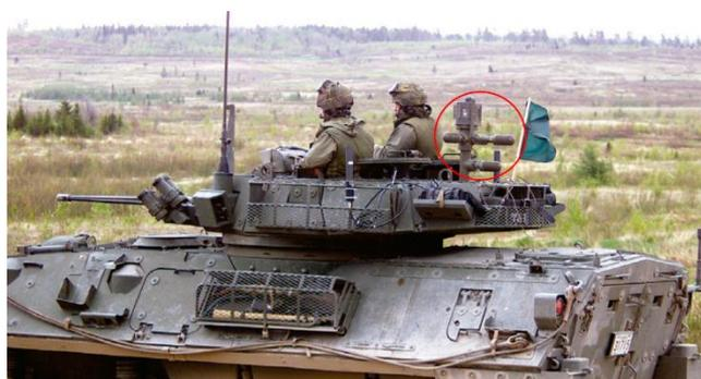
Figura: 3. Sistema de detección de disparos FERRET [5], sobre un vehículo blindado. El círculo rojo indica el arreglo de sensores acústicos en forma de tetraedro regular.
