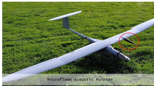
Figura: 1. Sensor acústico vectorial tridimensional del sistema “Acoustic Pointer” (círculo en rojo) colocado sobre el dron de ala fija que sirve de plataforma de transporte.
