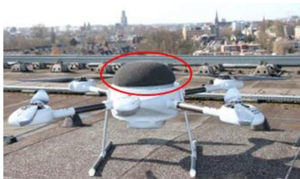
Figura: 2. Sensor de sistema “SKYSENTRY” (círculo en rojo) soportado sobre un dron y desplegado en una azotea.
