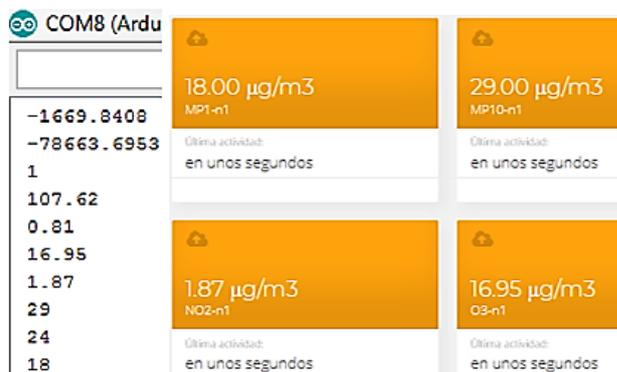
Figura 18: Datos supervisados del puerto serie del NCD y recibidos en la plataforma Ubidots.
