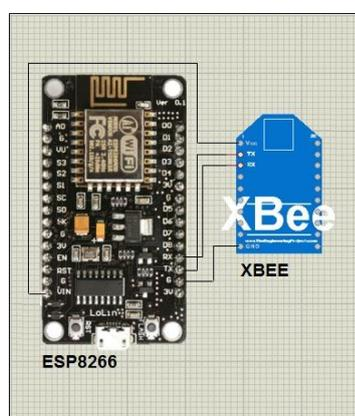
Figura. 5: Esquema de conexión NCD.
