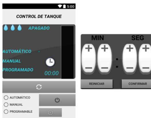
Figura 11: Vista previa de la pantalla de control del motor de agua y el Dialog de programación de tiempo.
