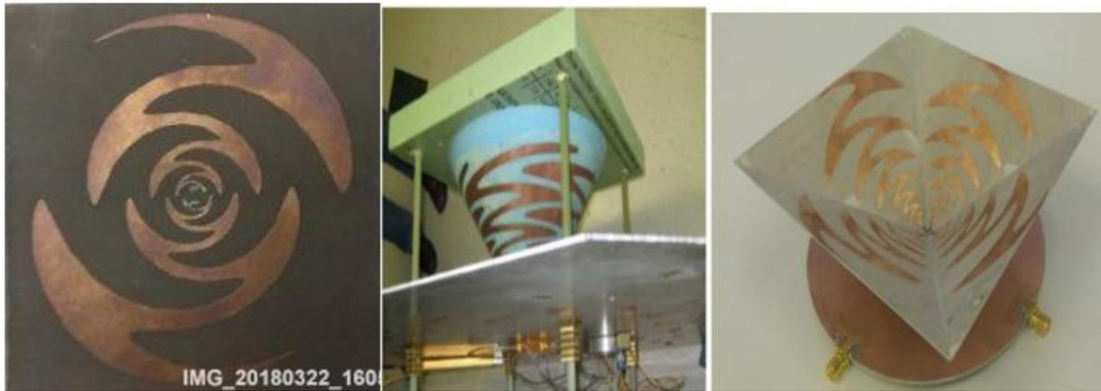
Figura 1. a) Antena sinuosa plana b) Antena sinuosa cónica[2] c) Antenas sinuosa piramidal[8].
