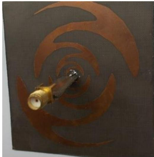
Figura 10. Antena Sinuosa construida con Balun conectado.
