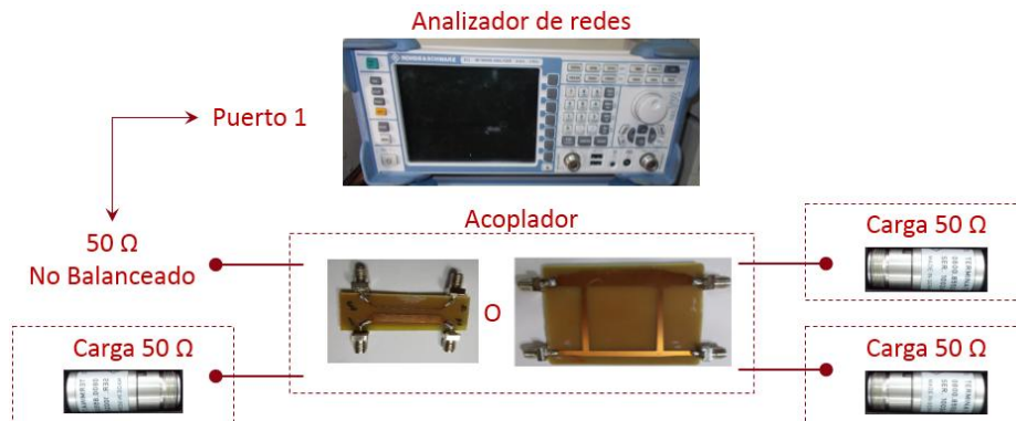
Figura 12. Esquema de conexión para medir los coeficientes S11.
