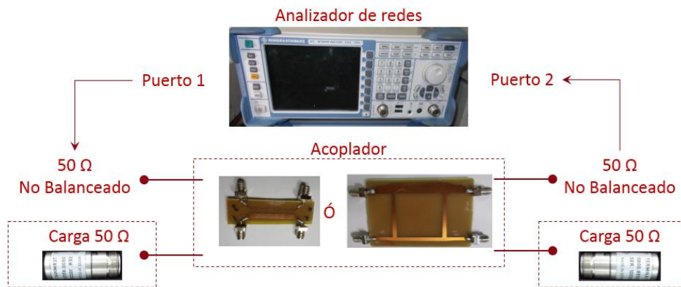
Figura 11. Esquema de conexión para medir los coeficientes S12, S13, S14.
