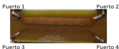
Figura 2. Acoplador direccional de líneas acopladas clásico.
