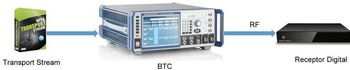
Figura 11: Esquema de Transmisión utilizado para la comprobación en los receptores DTMB.
