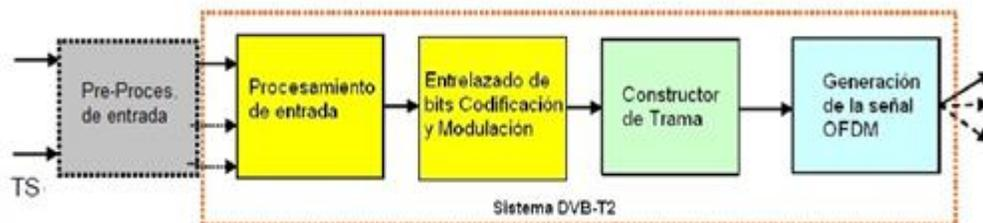
Figura. 1 Estructura general del sistema DVB-T2.
