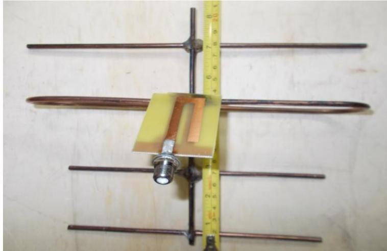
Figura 13. Implementación del Balun en una antena Yagi dipolo doblado.
