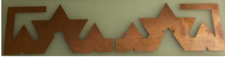
Figura 15 Implementación del Balun en una antena fractal.
