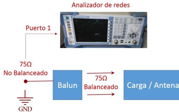
Figura 8. Esquema para la medición del coeficiente  $S_{11}$  del Balun con una carga.
