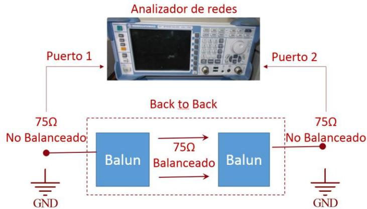
Figura 11. Esquema del seguido para medir el coeficiente  $S_{21}$  del *Back to back*.
