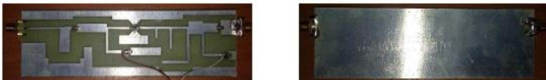
**Figura 11. Vista superior e inferior del amplificador clase E implementado a prueba de concepto.**
