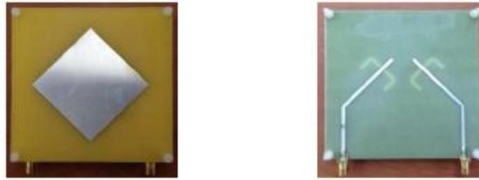
**Figura 9. Vista superior e inferior de la antena AAPC construida a prueba de concepto.**
