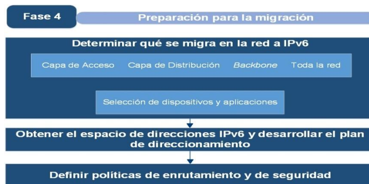
Figura 5: Fase 4 del procedimiento para la migración a IPv6 [10].
